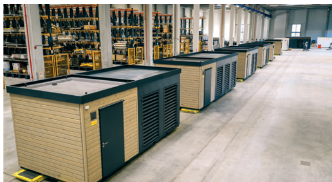
Die Energy Unit von Vaillant entsteht nicht auf der Baustelle, sondern in der Produktion von Alois Müller (als industriell gefertigtes Systemmodul)
