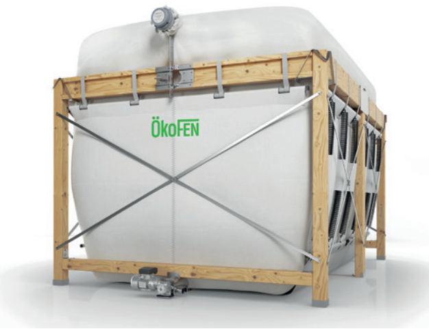
Der Gewebetank passend zum Condens XL fasst bis zu 12,5 t Pellets. Dank Funktionsprinzip mit Zugfedern und elastischem Schrägboden kann der vorhandene Platz voll ausgenutzt und der Gewebetank maximal befüllt werden.
